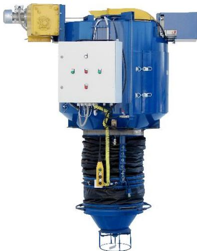
Рукав представляет собой телескопическую двухканальную коаксиальную конструкцию (труба в трубе). По внутреннему каналу осуществляется подача сыпучего материала. Уловленная пыль удаляется в пространстве, образованном наружной поверхностью этого канала и коаксиально расположенным гофрированным рукавом.
